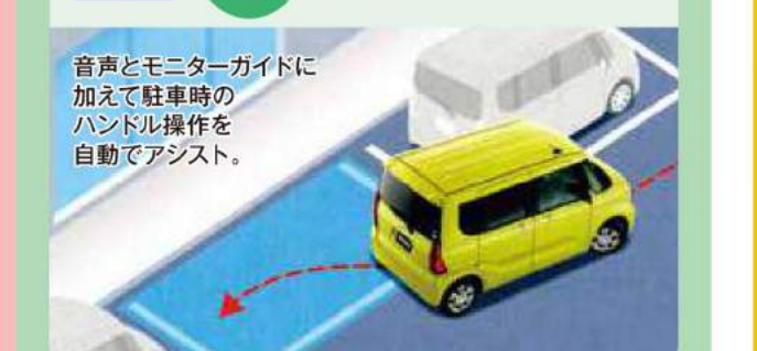
音声とモニターガイドに加えて駐車時のハンドル操作を自動でアシスト。
